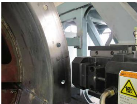
Fan Duct Punching
